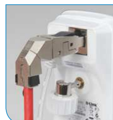
directe aansluiting– IP-camera
